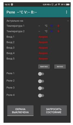
Главный экран отображает текущее состояние устройства. Текущее состояние приложение получает из СМС по нажатию кнопки «ЗАПРОСИТЬ СОСТОЯНИЕ» С главного экрана можно запрашивать состояние, включать и выключать реле, включать и выключать охрану.
