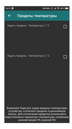
На данном экране можно задать/удалить устройству пределы температуры, при достижении которых устройство будет оповещать Вас об Аварии.
