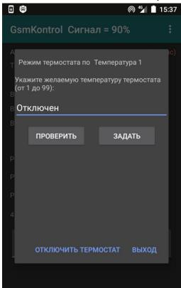
Доступны Температура 1, Температура 2 и Вход1, преобразованный в температурный
