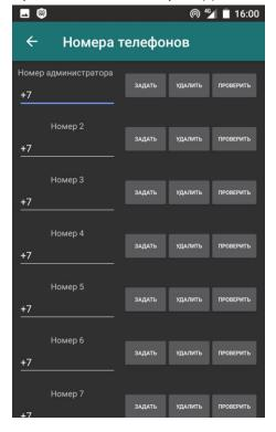
На данном экране можно задать/удалить устройству номера телефонов, с которых оно будет управляться. Если Вы уже ранее задавали номера телефонов, с других устройств или посредством СМС, то можно сначала проверить номер, записанный в памяти устройства. Если результат проверки вернул номер телефона, повторно задавать его уже не нужно.
