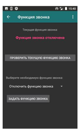
Устройство может управляться звонком. Для настройки функции звонка необходимо зайти в главное меню «Настройка функции звонка». По умолчанию функция звонка отключена. Рекомендуется перед заданием функции звонка проверить текущую функцию звонка, нажатием на кнопку «ПРОВЕРИТЬ ТЕКУЩУЮ ФУНКЦИЮ ЗВОНКА.
