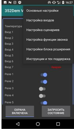
После появления блока расширения в меню становятся доступны настройки блока расширения. В настройках можно задать количество используемых входов, реле и датчика температуры.
