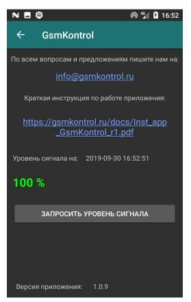
В главном меню заходим в пункт «Инструкции и тех поддержка». При нажатии на кнопку «ЗАПРОСИТЬ УРОВЕНЬ СИГНАЛА» приложение запросить уровень сигнала сотовой сети у прибора. При получении ответа от прибора, уровень сигнала прибора отобразится в % от максимального. Если уровень отображается красным цветом, необходимо произвести с прибором действия пол улучшению уровня сигнала.
