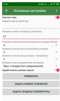
После выбора всех параметров нажимаем «Применить». Если все параметры заданы верно, то станут активными кнопки «Задать номера телефонов» и «Задать пределы температуры» (если выбран, хоть один датчик температуры».
